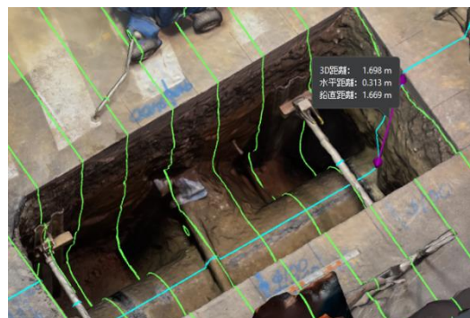
図-3 3次元モデル上での断面作成と寸法計測
