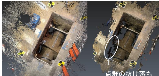
図-2 viDoc 法 (左) と通常法 (右) の点群の比較
