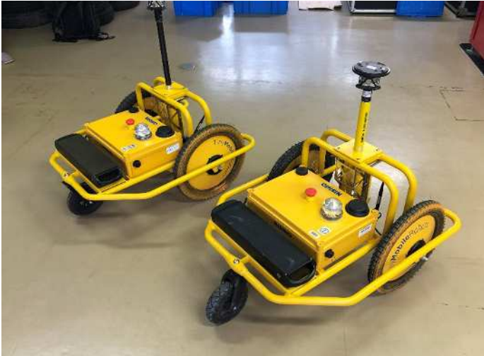
写真-1 マーキングロボット
