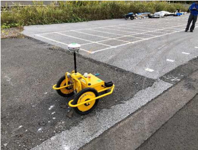
写真-2 確認実証状況 (GNSS 受信機)
