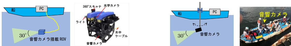
図-2 試験施工の方法（左：調査方法① ROVに搭載，右：調査方法② 船から音響カメラを吊り下げ）
