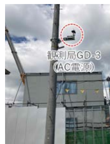
(a) 電柱上の観測局 (b) 自営柱上の基準局 写真-2 RTK-GNSS 設置状況
