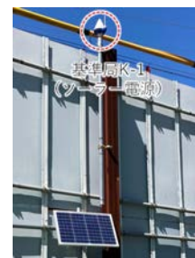
(a) 電柱上の観測局 (b) 自営柱上の基準局 写真-2 RTK-GNSS 設置状況
