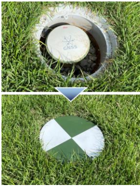
図-4 GNSS 樹ふた上部の塗色状況
