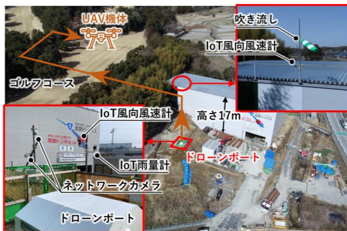
図-2 UAV 離着陸地点の気象観測状況
