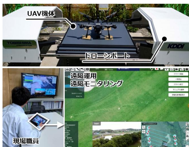
図-1 全自動 UAV の概要
