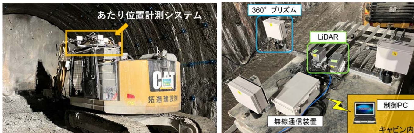
図-2 あたり位置計測システムの搭載状況
