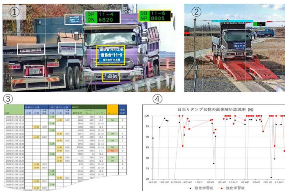
図-3 「複合ナンバー解析A I ダンプ入退場管理システム」
