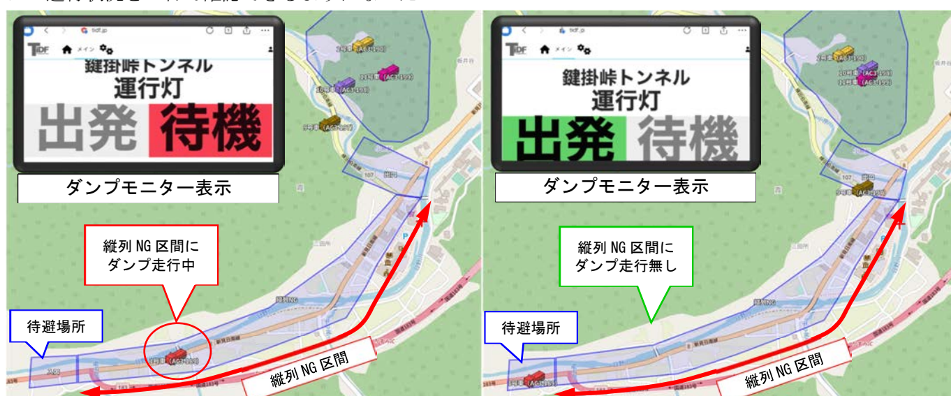
図2 マップでの運行状況表示とダンプモニター表示
