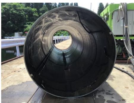
写真9 鋼管杭切断断面
