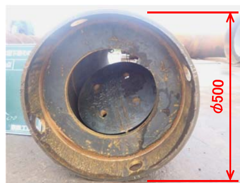
写真-6 スライム除去用ケーシングバケット （底部を撮影）
