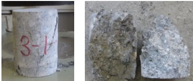
写真-4 圧縮強度供試体状況
