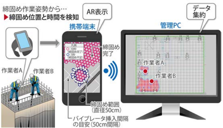
図-1 締固め管理システムの概要
