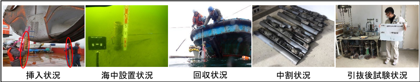
写真-2 塩ビ管試験状況
