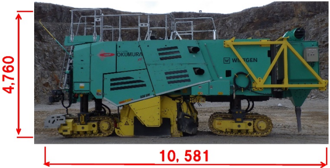
写真-1 新型岩盤切削機(220SM)の外観(左:側面 右:正面)
