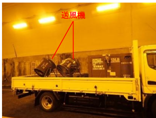
写真-1 送風機を用いた結露抑制装置
