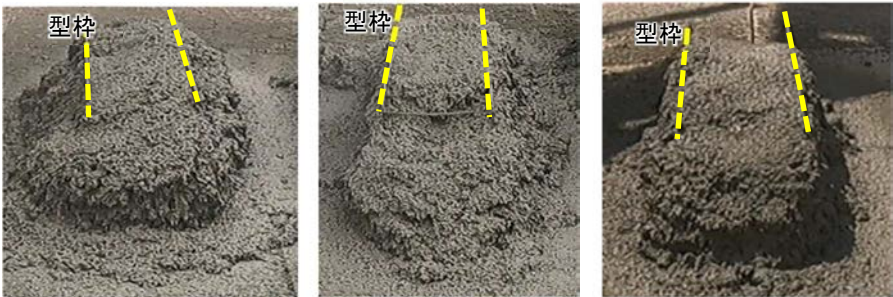
写真 1 吹付直後の供試体 (F-300)
