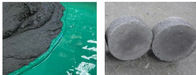
写真-2 接着剤の押出し状況
