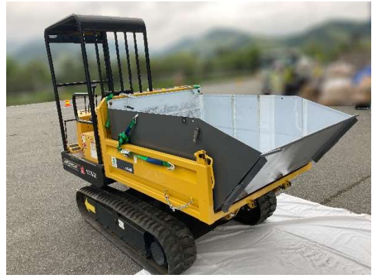
写真-2 2t キャリアダンプ 360° 回転
