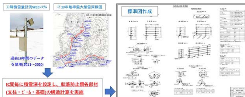
図-5 転落防止柵標準図作成の流れ
