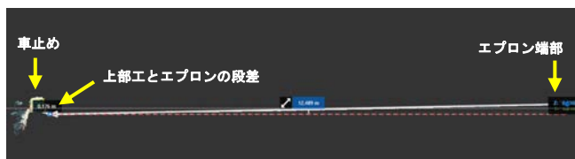
図5 三次元点群データ 断面図(No.1-4 中心側線)
