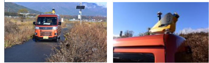
写真-1 小型 MMS での計測
