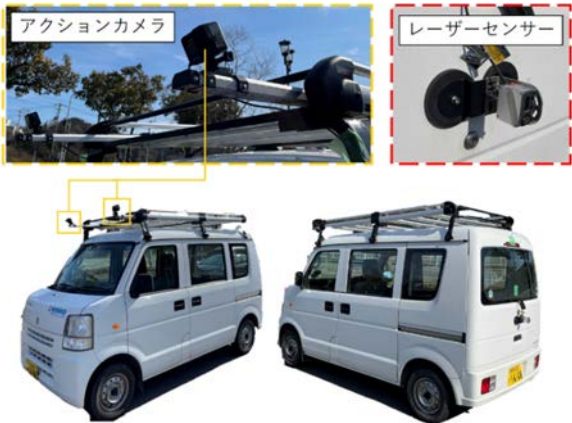
図-1 各種機器取付状況
