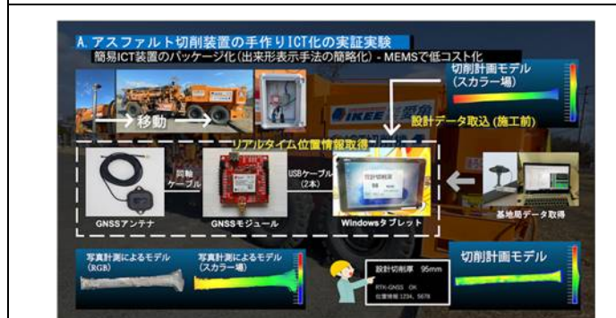
図3 設置手間を4工数に低減、設置時間を30分に短縮しユーザビリティを高める
