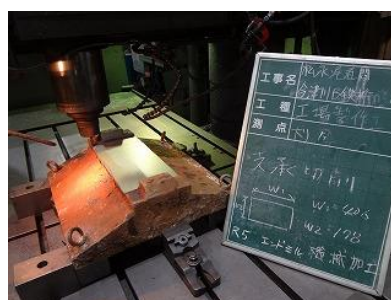
写真-4 沓切削状況
