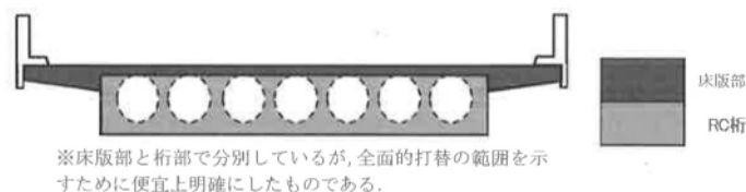
図-1 中空床版橋の打替え部位
