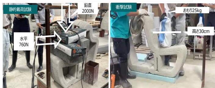
写真-1 静的載荷および衝撃試験の状況
