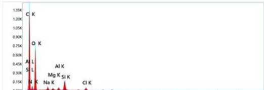
図2 AB 気中暴露品 成分検出状況
