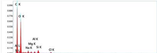
図1 CS 気中暴露品 成分検出状況
