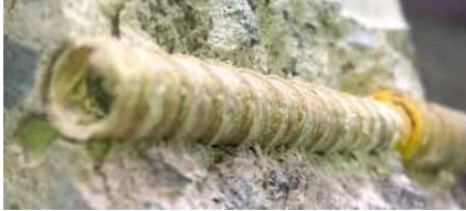
写真-3 実験後のアラミド异形棒材表面
