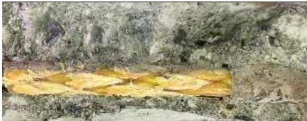
写真-2 実験後のアラミド組紐棒材表面
