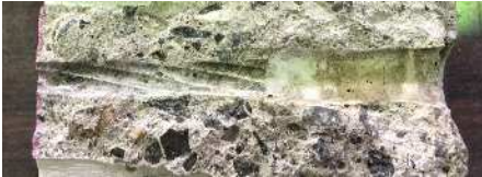
写真-1 実験後の炭素より線-コンクリート界面
