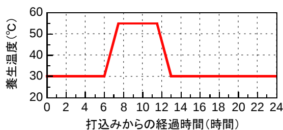
図-1 蒸気養生パターン
