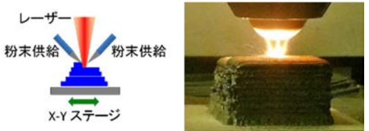
図 4 指向性エネルギー堆積法(DED)
