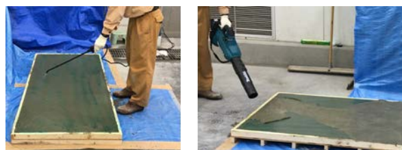
写真2 アルギン酸ナトリウム水溶液の散布状況(左)とブローによる不溶性ゲルの除去状況(右)
