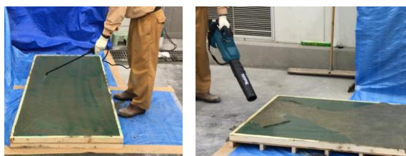
写真3 アルギン酸ナトリウム水溶液の散布状況(左)とブロアによる不溶性ゲルの除去状況(右)
