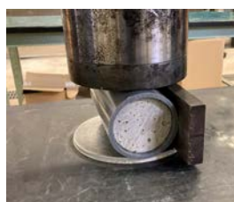
ひび割れ導入
