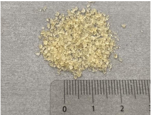
図-1 バクテリアを含む混和材（HA）
