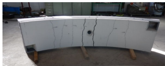
写真-2 載荷後試験体
