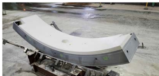
写真-1 脱型直後のセグメント
