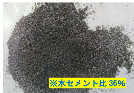
写真-1 フェノールフタレイン溶液噴霧後の状況
