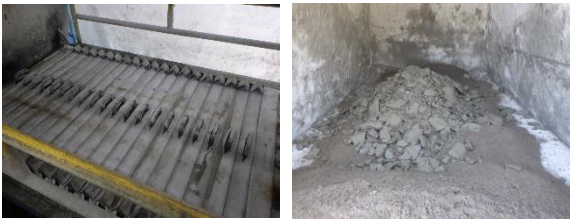
写真 1. 1 スラッジケーキ生成 (左)脱水処理 (右)生成直後
