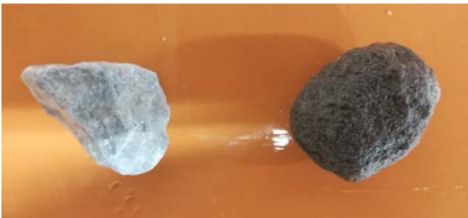
写真 1 新骨材(左)と粒状化骨材(右)
