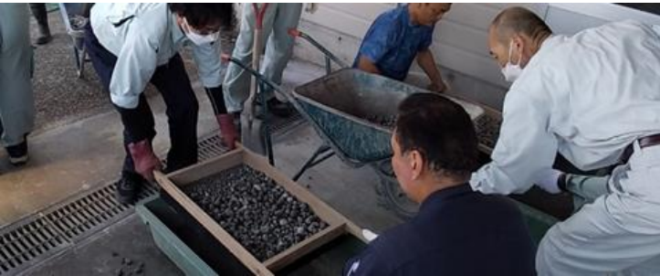
写真－2 粒状化再生骨材ふるい分け状況
