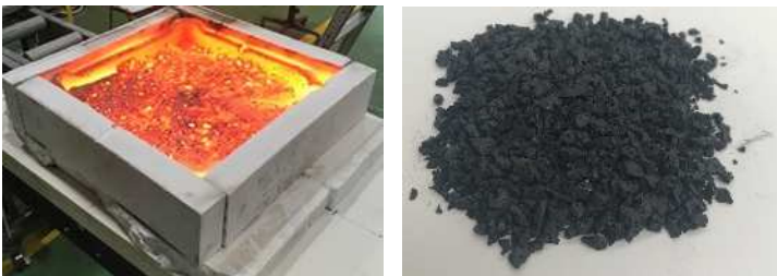
図 2. マイクロ波による焼結時の試料(左)および破碎（20mm 以下）した焼結体(右)
