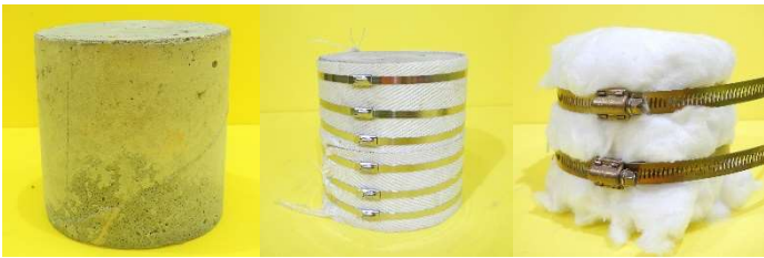
1) 供試体 2) 結束バンド 3) 断熱材 図-2 供試体概要
