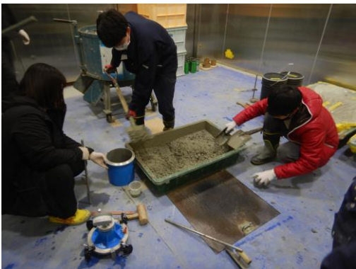
写真-2 コンクリート製造状況 (室温 10℃)
