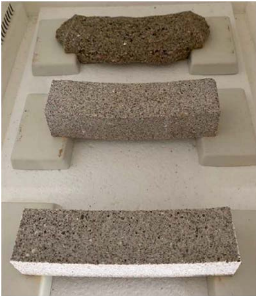
図 3 供試体外観(1150℃加熱後)
