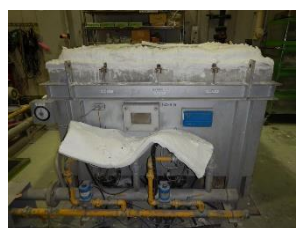
写真-1 耐火炉外観
