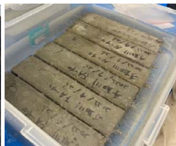
写真-2 膨張量試験 養生状況
