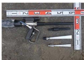
写真-5 吹付ノズル(中)
