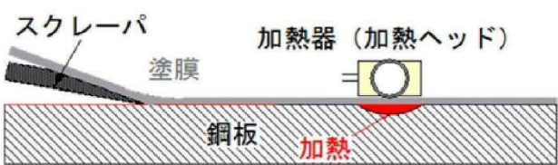
図-1 IH 塗膜除去工法の塗膜剥離イメージ
