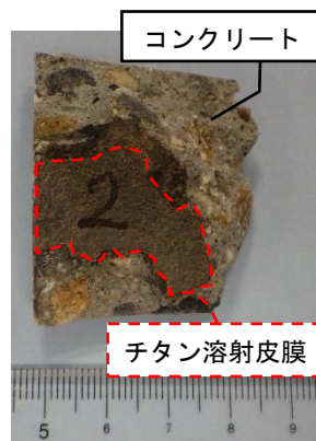
図 3 陽極皮膜が付着 したコンクリート片
