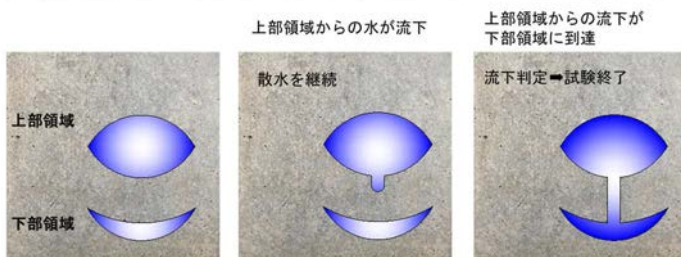
図1 散水試験の概要
