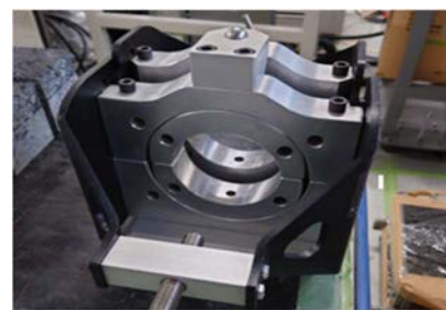
写真-1 円柱せん断試験の治具
